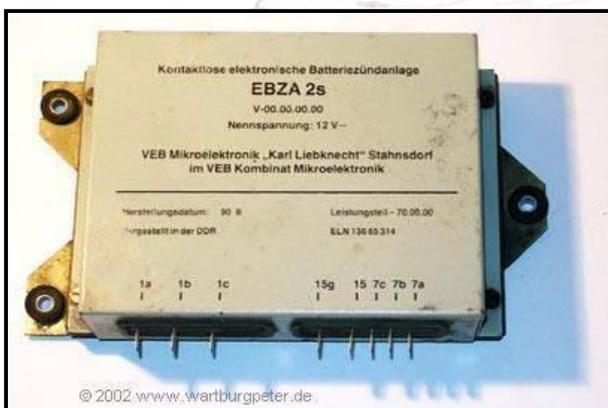
Ein Gutes hat die EBZA, sie ist vollständig diskret aufgebaut, besteht aus Bauelementen, die auch heute noch repariert und ersetzt werden können.
