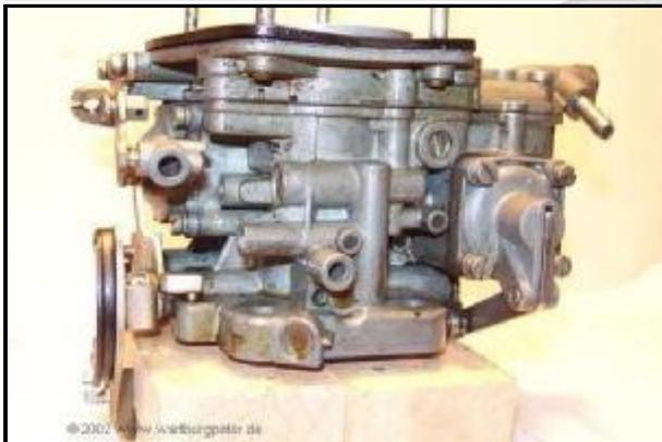
Deutlich sieht man den schon verstärkten Flansch, der dennoch an allen Stehbolzen nach oben verzogen ist.
